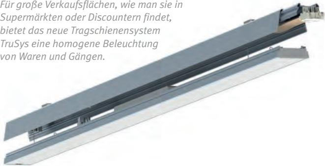
die Aufhängung sind in die Tragschienen versenkt, so dass sie von außen kaum sichtbar sind. Für eine bestmögliche Ausstrahlcharakteristik gibt es die Linsen in vier Varianten: doppelasymmetrisch für die Ausleuchtung von zwei Regalen, mit sogenannter »Wallwasher«-Charakteristik bei Regalen auf nur einer Seite oder zur Beleuchtung von Wänden, breitstrahlend für eine flächige Beleuchtung bei niedrigen Deckenhöhen und engstrahlend für hohe Decken zum Beispiel in Lagern.
